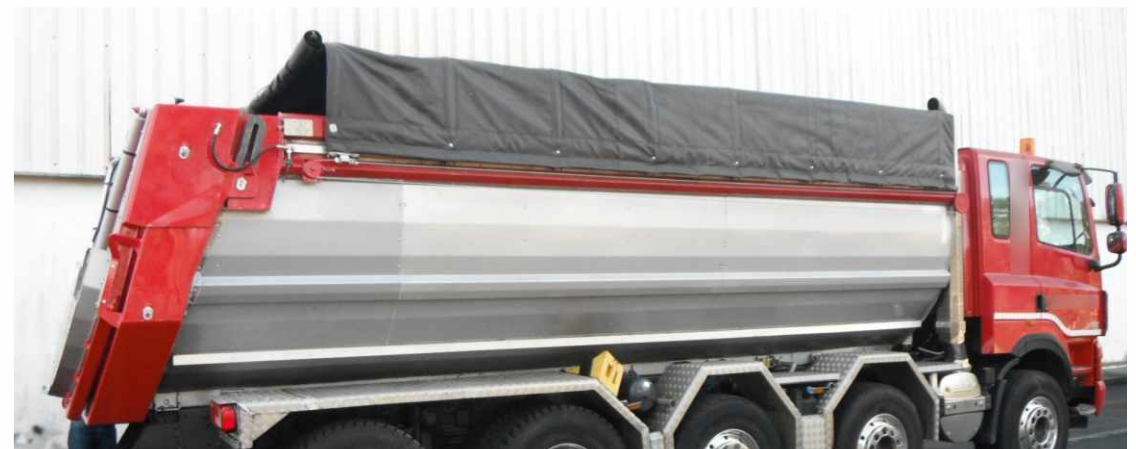
Benne Ronde version poussoir avec un vérin télescopique double effet, sans levage de la benne.
