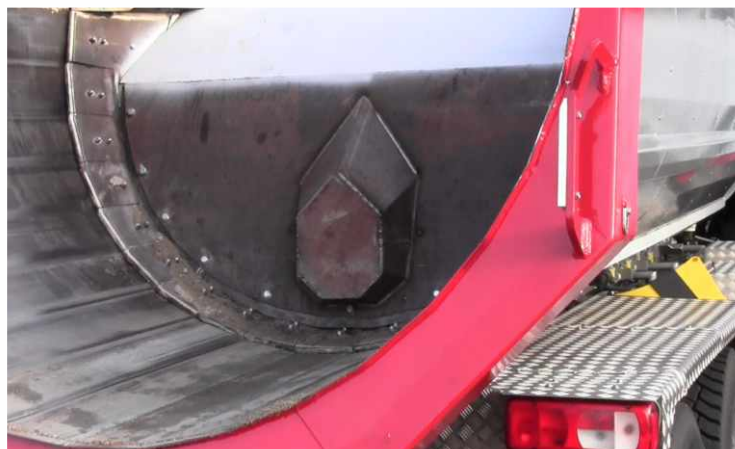
Benne Ronde version poussoir avec un vérin télescopique double effet, sans levage de la benne.
